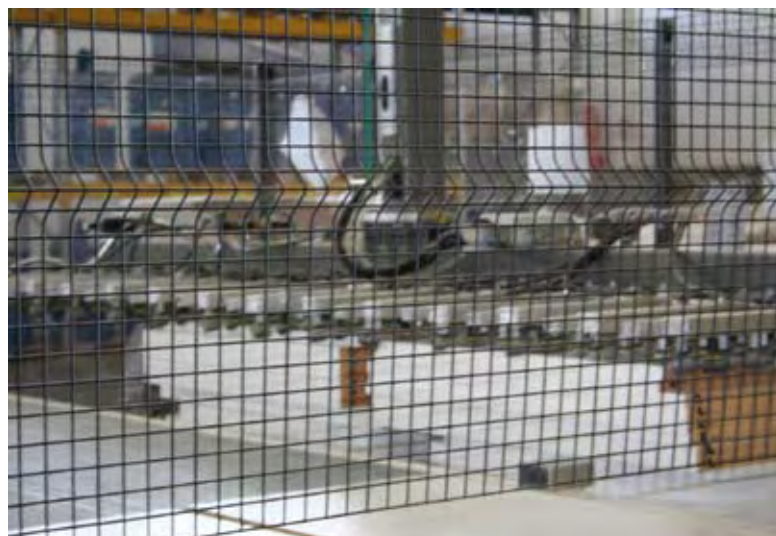
11 e 12 – Protetto da una gabbia di sicu- rezza, il sistema automatico che ribalta i pannelli di 180° per poi immetterli su una linea uguale e parallela alla precedente. 11 and 12 – Protected by a safety cage, the automatic system that capsizes the panels by 180°, and then introduces them into a line that is similar and parallel to the previous line.
