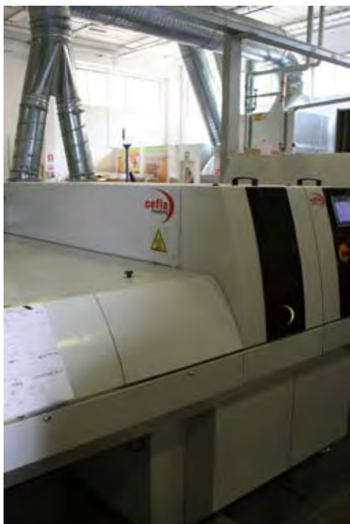
10 – La polimerizzazione finale tramite forno UV. 10 – Final polymerization by means of UV oven.
