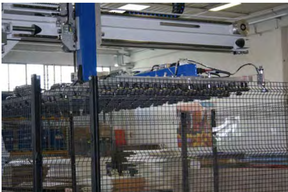
2 – Il caricatore automatico a ventose dei pannelli in legno.
