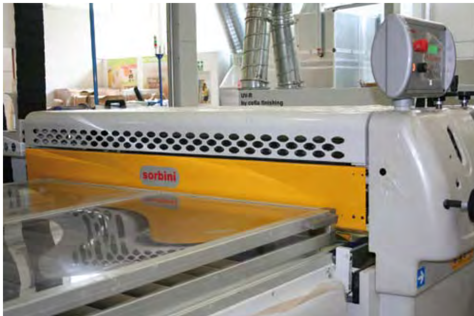
9 – L'impianto di spazzolatura finale. 9 – Final brushing plant.
