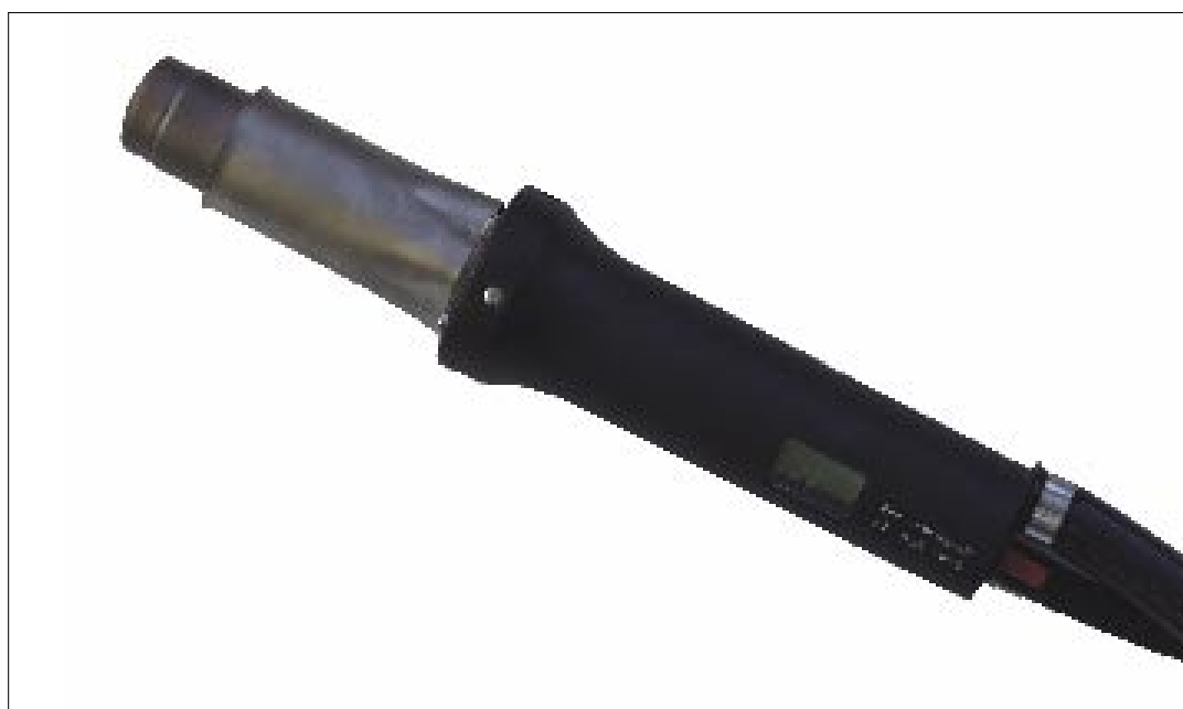
Fig. 6 - La pistola termica, per soffiare azoto riscaldato sui manufatti prima della verniciatura.
