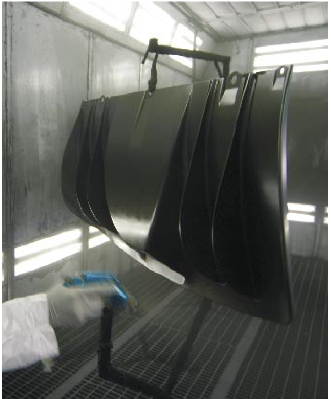
Fig. 8 - Un particolare in cabina durante la verniciatura: si noti la notevole differenza qualitativa del film, tra la parte destra, verniciata con l'ausilio dell'azoto e la sinistra trattata in modo tradizionale (dilatazione, distensione totale, brillantezza e basso overspray ) .
