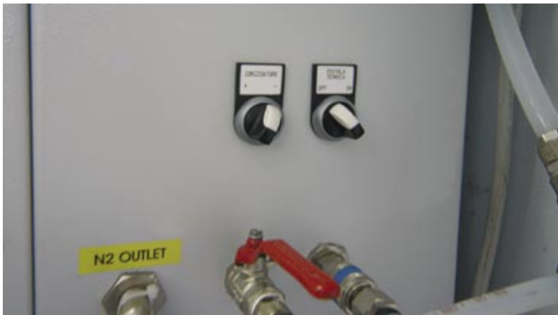
Fig. 7 - Gli interruttori montati sul modulo, per l'attivazione della pistola termica e per la commutazione positivo - negativo dell'azoto ionizzato erogato
