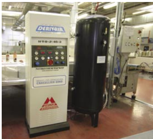
3 - Il generatore d'azoto ( Nitrothermospray J40 ) con il suo serbatoio.
