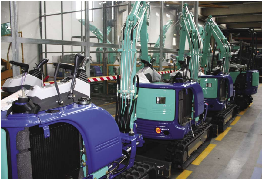
6 - Una delle due linee d'assemblaggio dei miniescavatori, a sinistra.
