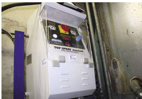
14 - Il modulo Top Spray consente la regolazione della temperatura dell'azoto ed è fornito in abbinamento al sistema Nitrothermspray.
