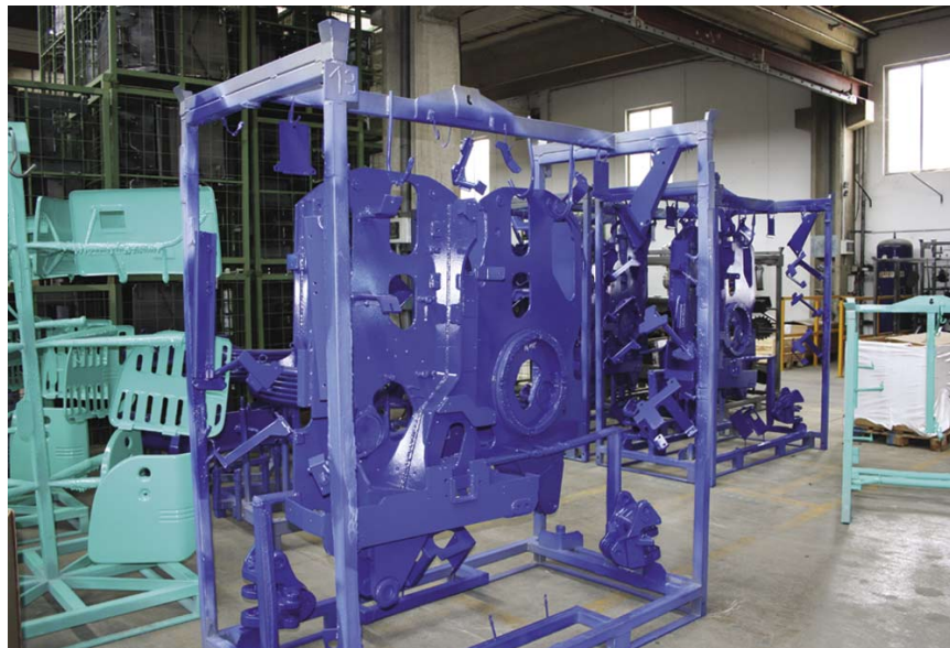
8 - Un modulo di assemblaggio caricato sulla bilancella all'uscita del reparto verniciatura.
